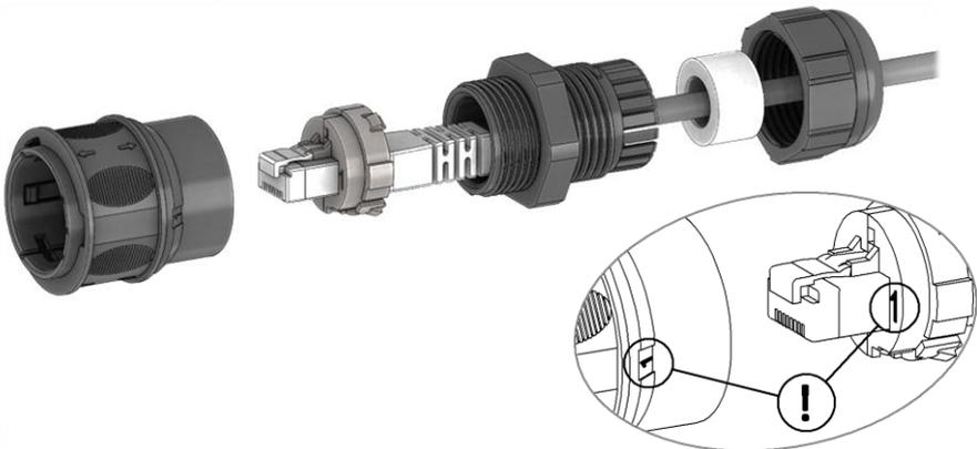
**Achten Sie beim Einsetzen der grauen Kabel-Manschette in das Gehäuse unbedingt auf die richtige Orientierung, siehe Bild.** Schieben sie die graue Manschette mit dem vormontierten Kabel in das Gehäuse, rastet sie dort mit einem hörbaren Klicken ein. Wird die Manschette falsch in das Gehäuse eingesetzt lässt sich das IP-67 Steckergehäuse nicht auf den EN-10 aufstecken.
